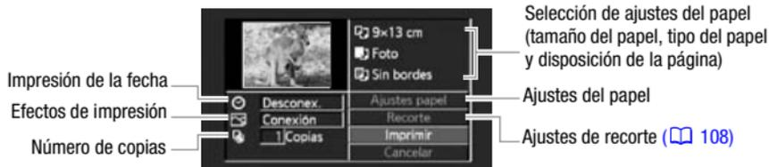
4 En el menú de ajustes de impresión, seleccione (▲▼, ▶◀) el ajuste que desee cambiar y pulse (SET).
