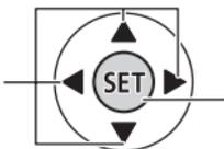
Pulse la palanca de mando (SET) para guardar las opciones o confirmar una acción. En las pantallas de menú, esto se indica mediante el símbolo SET (ajuste).
